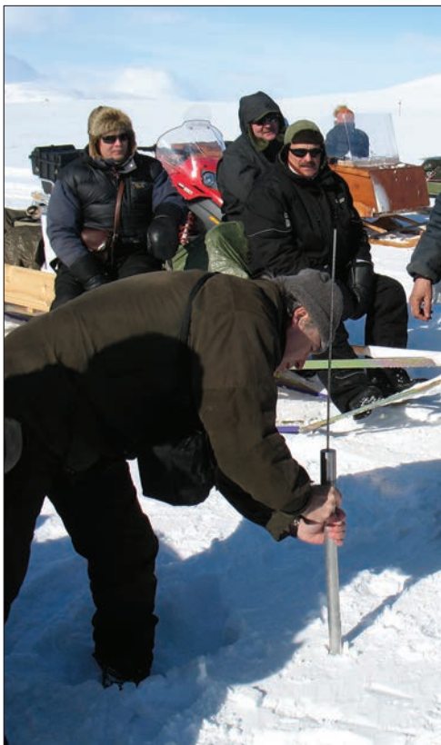
Figur 4. Hardhetsmåling med penetrometer.
